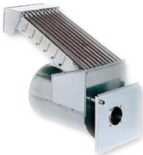
Intercambiador de calor patentado, de alto rendimiento, con el flujo de aire totalmente contrario a la trayectoria del humo, hecho completamente de acero inoxidable al 18% de cromo, lo que garantiza una protección completa contra la corrosión y la humedad ambiente y de los productos de combustión. El intercambiador de calor está constituido por:
